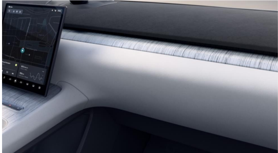
图 58：蔚来 ET7 搭载的隐藏式智能出风口
