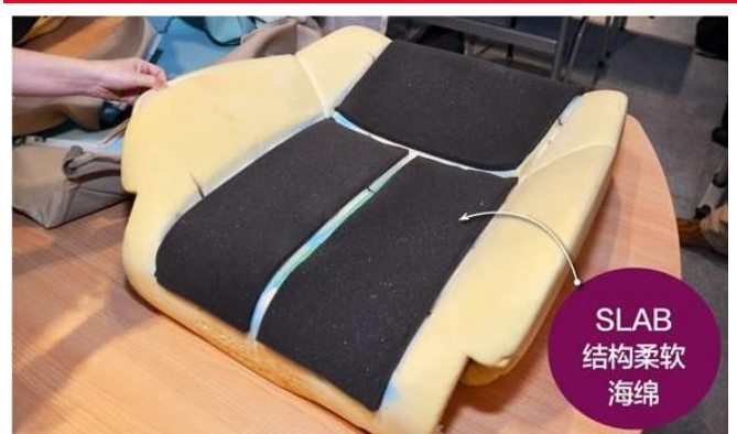
图29 日产天籁零重力座椅中的 SLAB 结构
