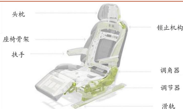
图 7：乘用车座椅主要结构
