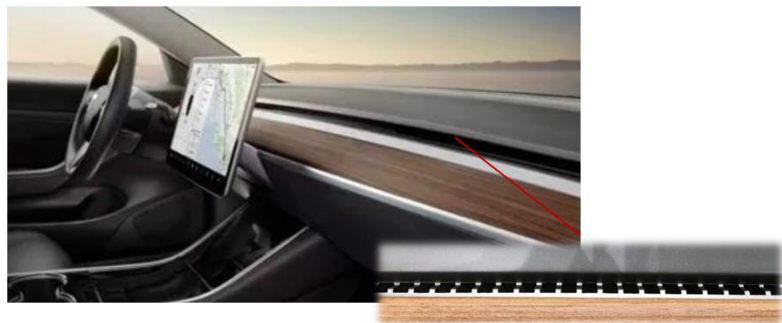
图 3：隐藏式电动出风口能够实现工程与造型设计的完美融合
