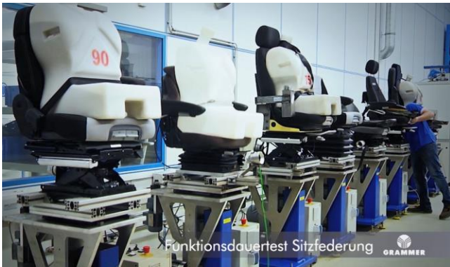
图 10：格拉默商用车和非道路机械座椅试验
