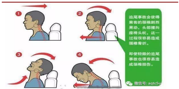
图 19: 汽车头枕作用示意图
